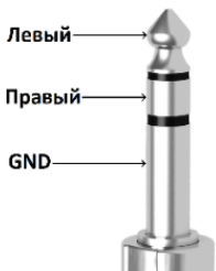
Рисунок 4 – Цоколёвка разъёма Jack 6.3mm 3pin
